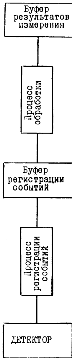
Рис. 1. Схема эксперимента на этапе измерений при последовательном выполнении процесса регистрации и процесса обработки.
