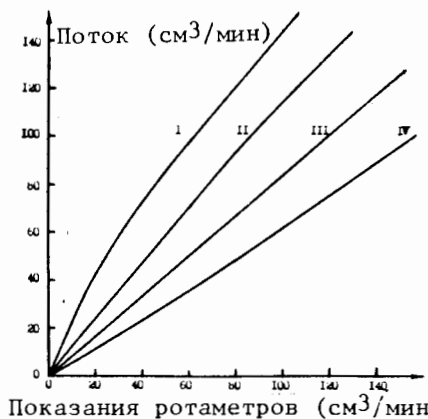
Рис.8. Калибровочные кривые ротаметров для изобутана /I/, углекислого газа /II/, аргона /III/ и неона /IV/.
