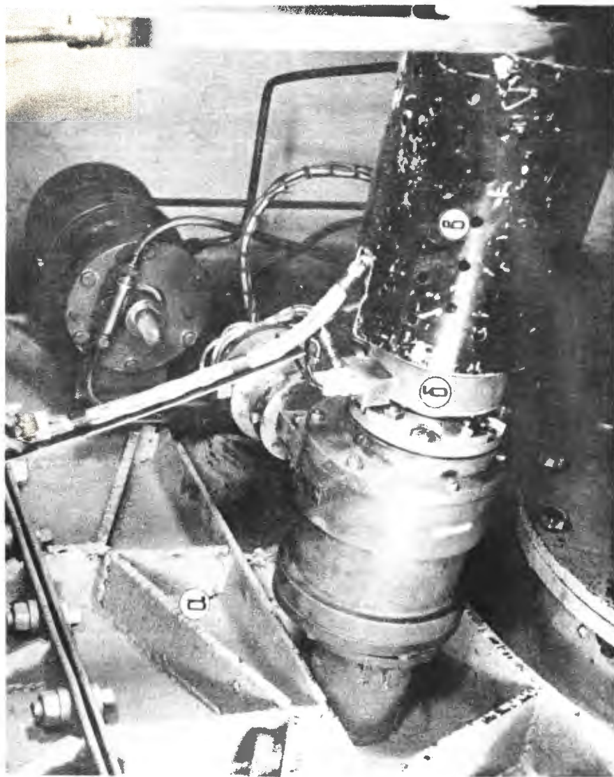
Рис.5. Общий вид части ионопровода на участке инжекции: а) линейный ускоритель протонов 0,4 Мэв, б) магнитоиндукционный датчик, в) корректор.
