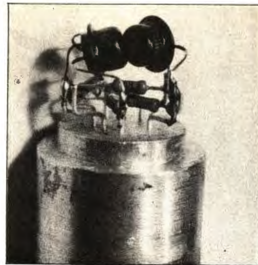
Рис.2. Монтаж объемного модуля.
