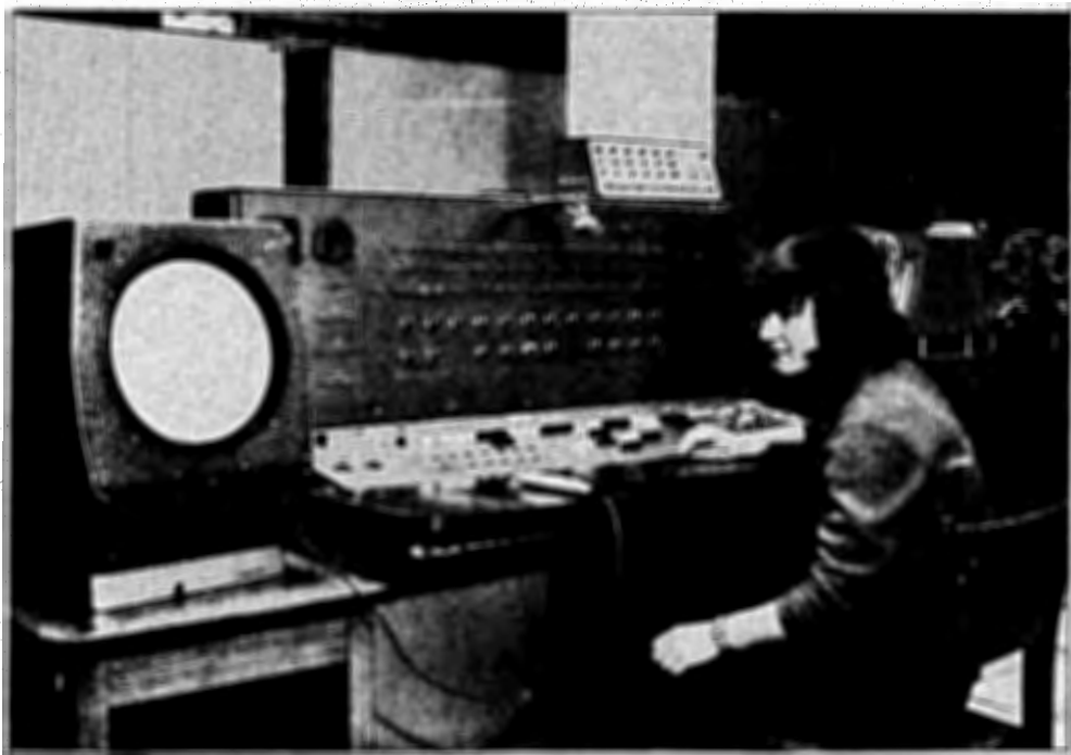
Рис.2. Общий вид осциллографа со световым карандашом.
