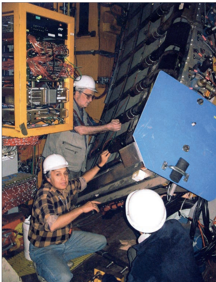
Профилактические работы с детекторами системы мюонного триггера CDF. 2007 г.
