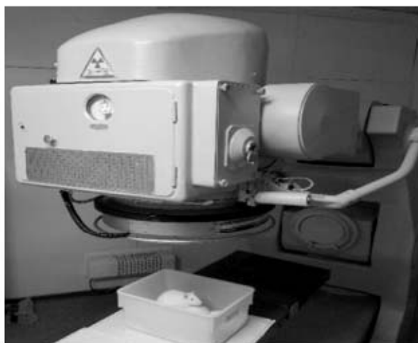
Рис. 1. \gamma -облучение крыс на установке Рокус-М.
