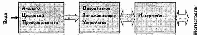
Рис. 5. Способ построения цифрового регистратора формы сигналов.
