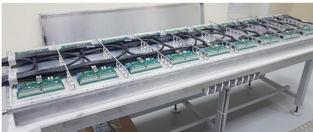
Рисунок 18 – Расположение усилителей и кабелей в модуле
