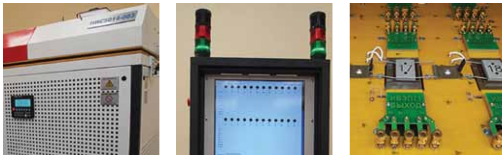
Рис. 1. Стенды испытаний на безотказность и ЭП тепловыделяющих изделий производства АО «НПЦ «ЭлТест»
