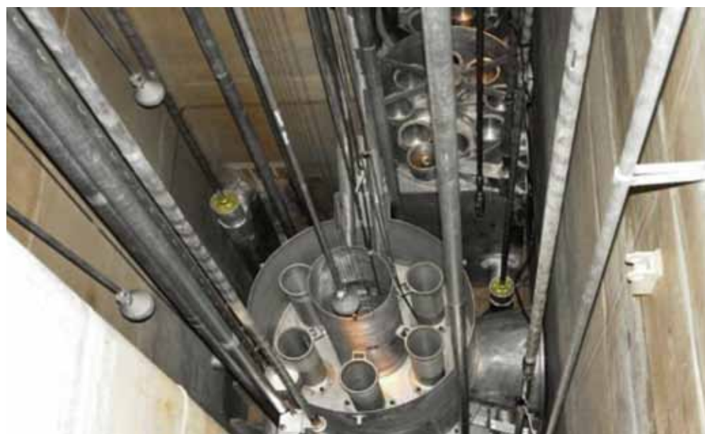
Каналы для легирования монокристаллов кремния диаметром 200 мм
