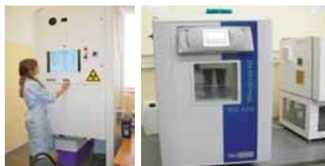
Рис. 1. Камера «тепло-холод-влага» ТСС 4010 (справа), рентгеновский комплект «FILIN-122/160» (слева)
