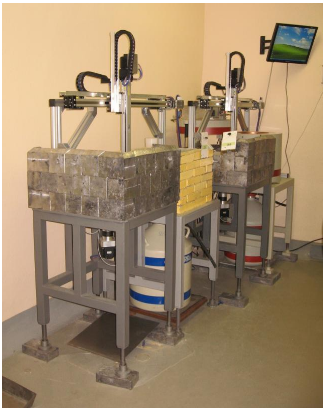
Рисунок 3. Общий вид устройств автоматической смены образцов
