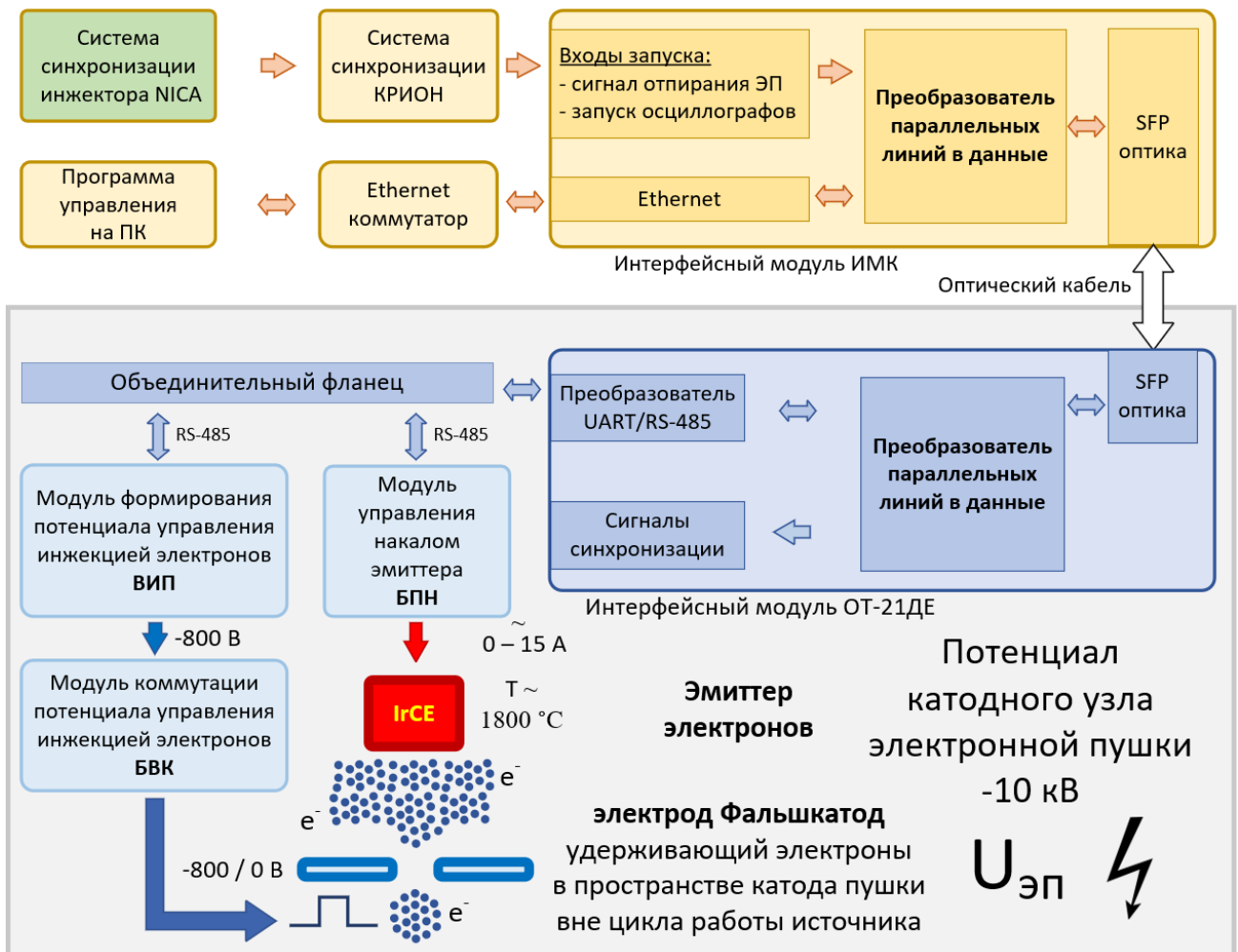
Рисунок 3. Структурная схема системы управления инжекцией электронов источников ионов КРИОН.
