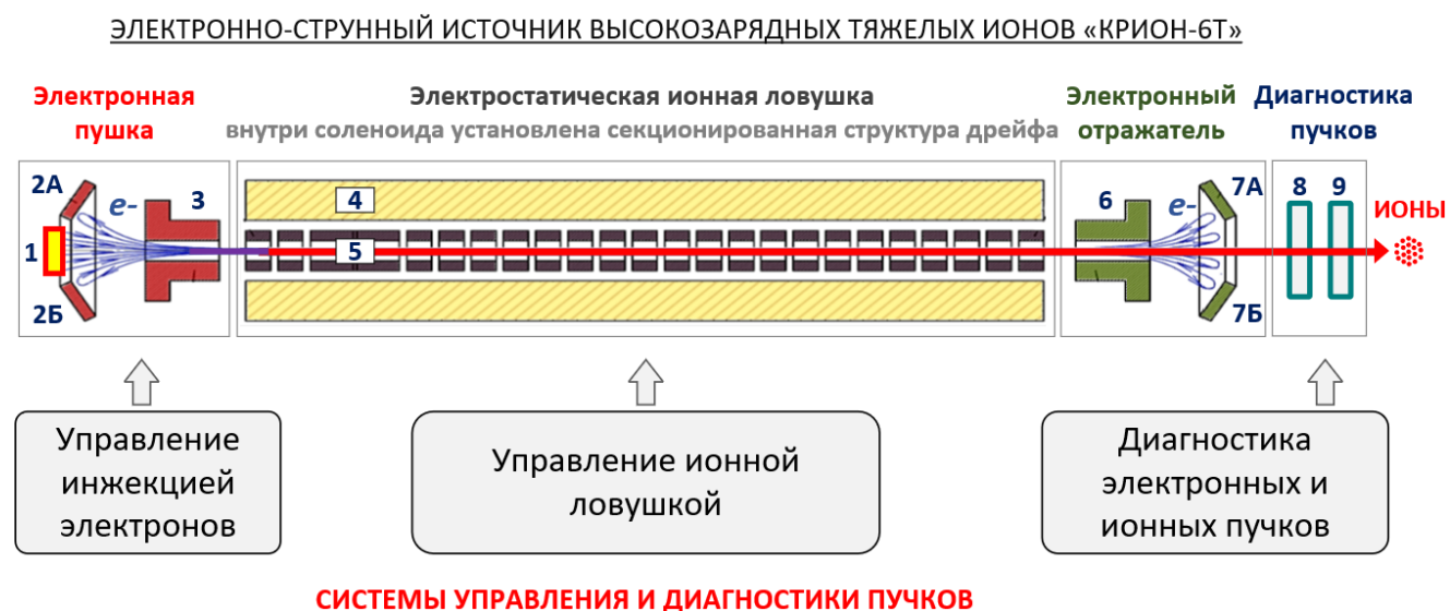
Рисунок 1. Структурная схема источника ионов КРИОН-6Т:
