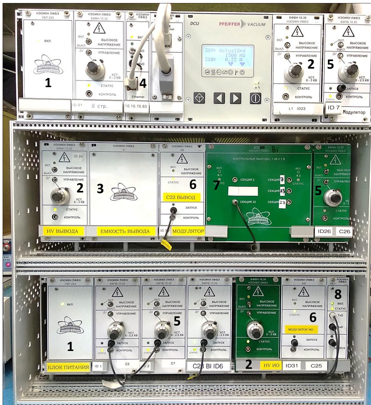
Рисунок 9. Разработанные и созданные автором электронные модули системы управления ионной ловушкой ЭСИ КРИОН-6Т:
