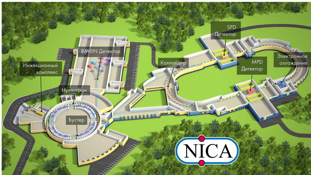
Рис. 1. Схема ускорительного комплекса проекта «Комплекс NICA»
