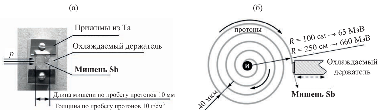
Рис. 1. (а) мишень Sb, (б) схема облучения.
