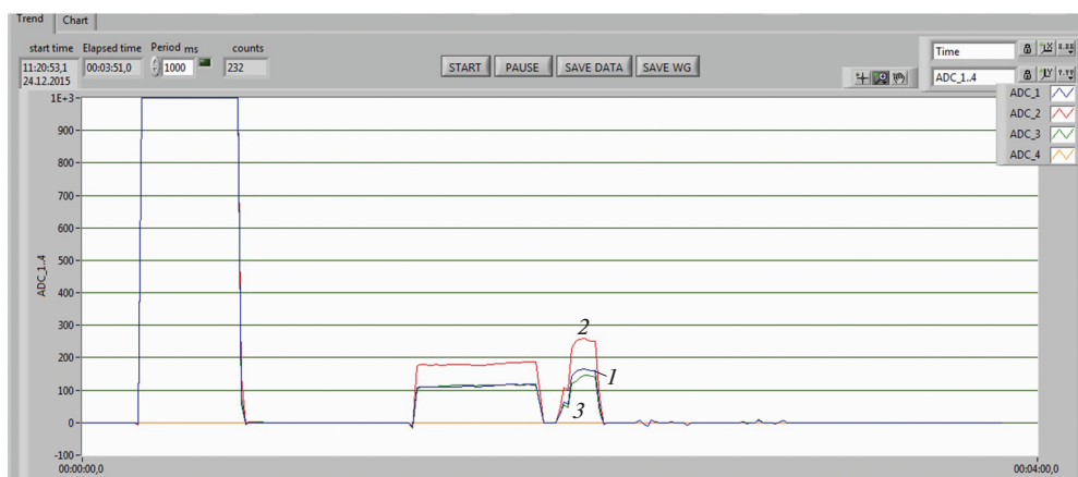
Рис. 6. Результаты измерения тока пучка ионов ^{32}\text{S} с энергией 51 МэВ/нуклон с помощью трехламельного пробника, установленного на последней орбите циклотрона МЦ-400. Показания токов ADC_1–ADC_3 соответствуют измерениям токов с верхней (1 – ADC_1), центральной (2 – ADC_2) и нижней (3 – ADC_3) ламелей.
