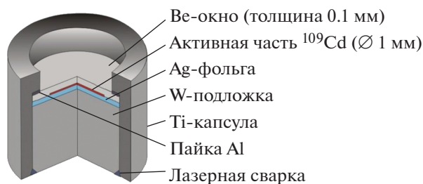
Рис. 1. Схема устройства источника ^{109}\text{Cd} диаметром и высотой 3 мм.
