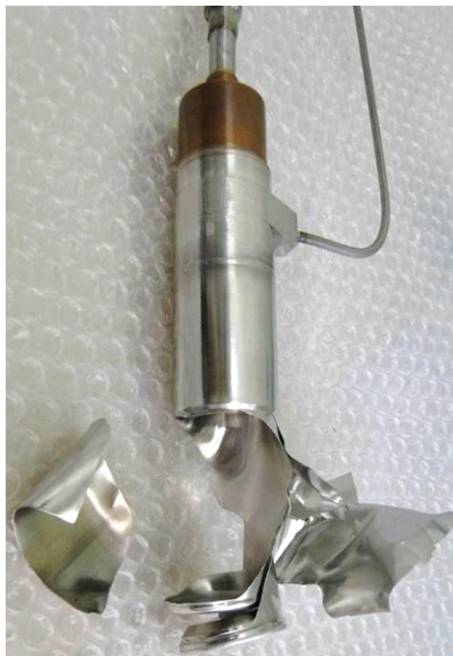
Рис. 4. Внешний вид макета ампулы № 1 после испытаний на несущую способность.
