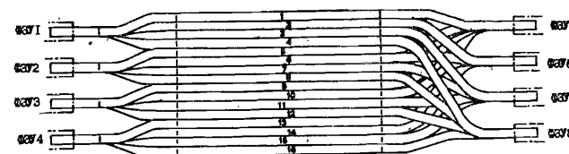
Рис. 1. Схема кодирования сцинтилляционного годоскопа с помощью итеративного кода типа ИЛИ-ИЛИ.
