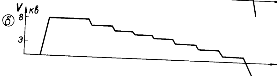
Схема ионизатора с накоплением поляризованных ионов: 1 - кольцевой катод, 2 - анод, 3 - дрейфовая трубка, 4 - коллектор электронов, 5 - вытягивающий электрод, 6 - соленоид; а - распределение потенциалов в ходе накопления ионов, б - распределение потенциала при вытягивании ионов.
