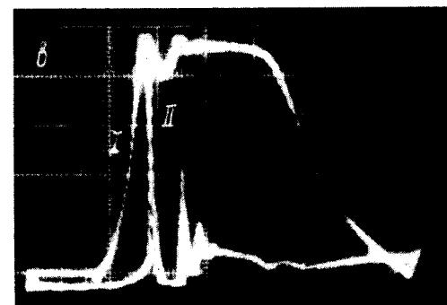
Рис. 4. Осциллограммы показаний фотоэлектрического (I) и пьезоэлектрического (II) датчиков. Датчик (II) расположен в полости (10). Давление в управляющей магистрали 3 ат. Одна клетка координатной сетки соответствует 10 мсек. случай "а" - щель между деталями (7) и (11) оптимальна, случай "б" - щель меньше оптимальной, случай "в" - щель больше оптимальной.
