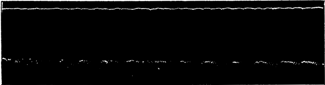
Рис. 1. Эффект действия схемы компенсации возмущения равновесной фазы \phi_0 за счет гармоник пульсаций магнитного поля при малых значениях амплитуды ускоряющего напряжения V_1 = 20 кв в течение всего цикла ускорения. Осциллограммы а и б - сигналы интенсивности, в - сигнал потерь с мишени; а) без работы схемы компенсации, б) схема компенсации действует, в) нижний луч - потери частиц без компенсации, верхний луч - эффект компенсации.
