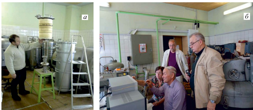
Рис. 18. Отдел криогенных исследований НПЦ по материаловедению НАН Белоруссии: подготовка резонатора к погружению в криостат (а); гелиевые испытания резонатора № 2 (б)
