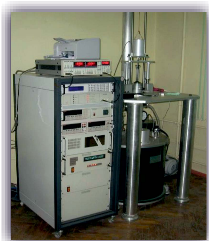
Рис. 19. Измерения сверхпроводящих характеристик сварных швов. а) Измерительная система «Liquid Helium Free High Field Measurement System»; б) образцы особо чистого ниобия: 0,1 и 0,2 — контрольные образцы, вырезанные из материала, который не подвергался термическому воздействию; 1,1 и 1,2 — образцы из сплошного листа ниобия после воздействия электронным лучом; 2,1 и 2,2 — образцы из сварного соединения, полученного с помощью ЭЛС
