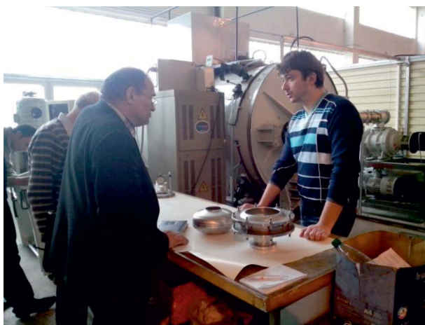
Рис. 10. Участок электронно-лучевой сварки в ФТИ НАН Белоруссии: установка для ЭЛС
