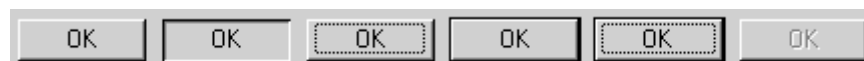
Рис. 32. Состояния кнопки в Windows: нейтральное, нажатое, нейтральное с установленным фокусом ввода, состояние кнопки по умолчанию, по умолчанию с установленным фокусом ввода и заблокированное.
